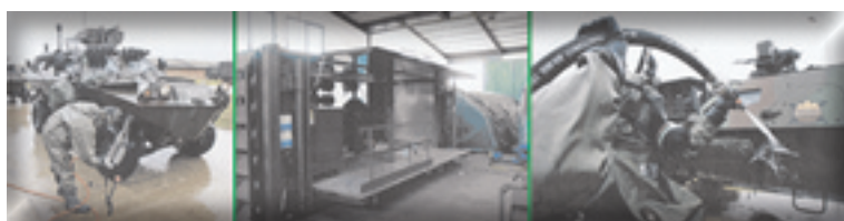
Obr. 3 Dekontaminace pomocí dekontaminačního kontejneru
