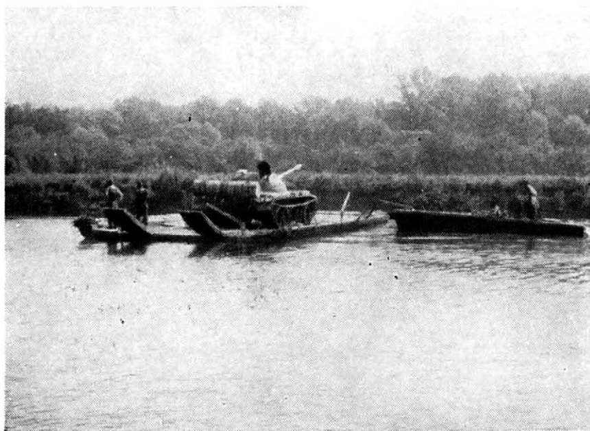
Obr. 3. 40 t soulodí PMS s tankem T-54 v čelním postrku člunem Mo 111
