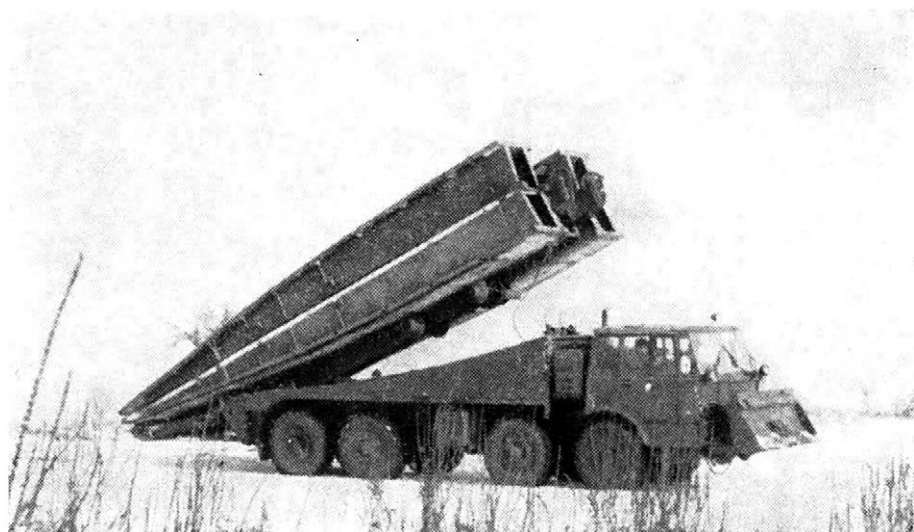
Obr. 4: Překlápění mostu v počáteční fázi přemostování překážky
