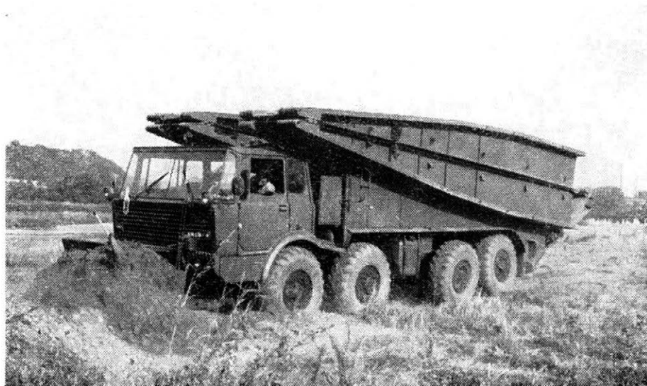
Obr. 1: Dopravní sestavení PM-55 s buldozerovým zařízením při terénní úpravě
