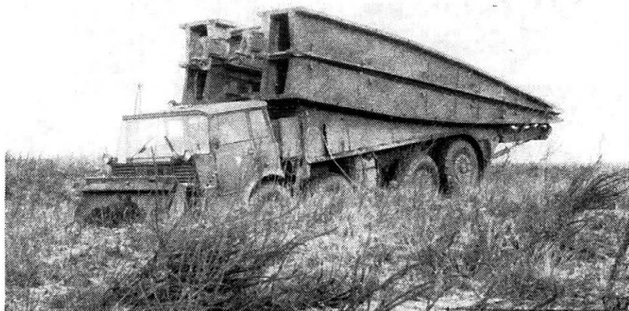
Obr. 3: Naložený sevřený most na přepravníku PM-55
