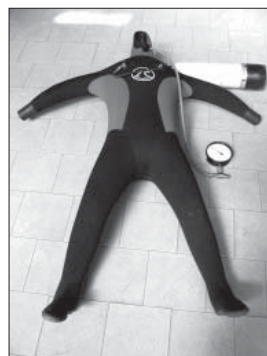
Obr. 16: Zkouška těsnosti suchého potápěčského obleku
