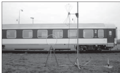
Obr. 1: Zkouška vagónu podle drážních norem
