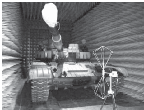
Obr. 2: Zkouška tanku podle ČOS 599902 (MIL-STD-461E)
