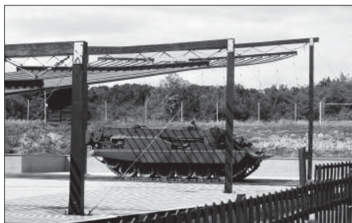
Obr. 8: Pracoviště simulátoru NEMP (nukleárního elektromagnetického impulzu)
