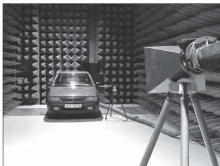
Obr. 9: Pracoviště provádění zkoušek HPM
