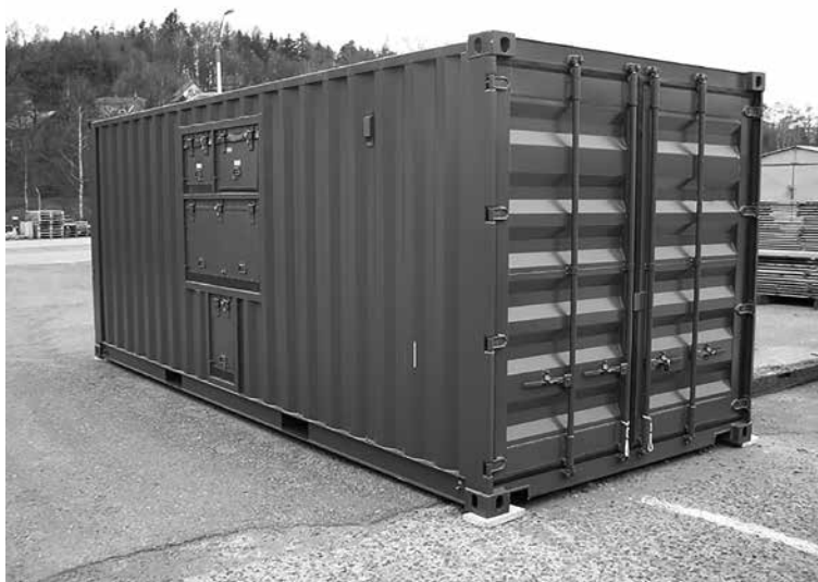
Obrázek č. 20: Zdroj elektrické energie (elektrocentrála EC 128 kW)
