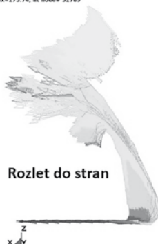
Obrázek č. 3: Simulace rozletu střepin z pletiva při použití páskové plastické trhaviny
